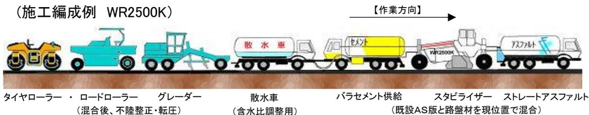
◎路盤の打ち換えと比較し、材料輸送時や廃材搬出時の環境負荷量が減り、またAs混合時の製造についても環境負荷量が減ることから、再生材を用いた瀝青安定処理路盤に対して、**路上路盤再生工法は、CO2排出量が約35%削減されることが、試算されています。**
